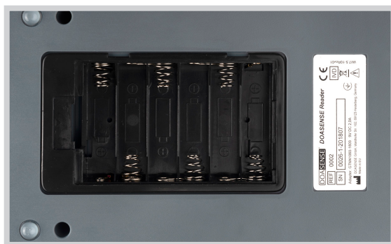
Joonis 11: Patareipesa DOASENSE Lugeja allosas
