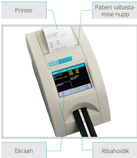
Joonis 2: Instrumendi esiosa kirjeldus
