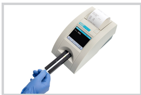
Joonis 6: Testriba asetamine DOASENSE'i Lugeja ribahoidja alusele
