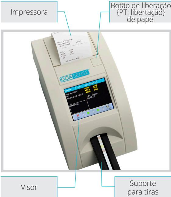
Figura 2: Descrição da parte frontal do instrumento
